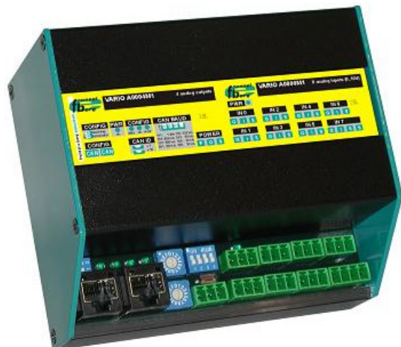
Metall-Gehäuse aus Aluminium-Strangguss
