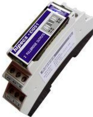
Das **hipecs CIO51** Modul ist ein universelles **CANopen IO Modul** zur dezentralen **Erweiterung** der **Ein- und Ausgänge** von Steuerungssystemen. Mit diesem Modul kann das System um bis zu **2 Vollbrückentreiber** für DC- Motoren via **CANopen** schnell und komfortabel erweitert werden. Einsatzgebiete sind z.B. Maschinen, industrielle Anlagen und Gebäude.
